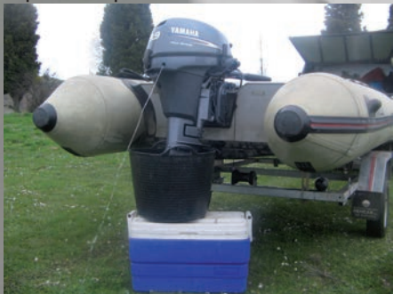
Limpieza del circuito de refrigeración del motor
